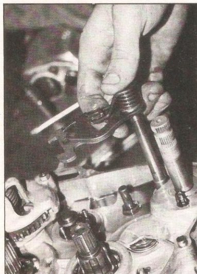
25) Installing the shifter rod.
